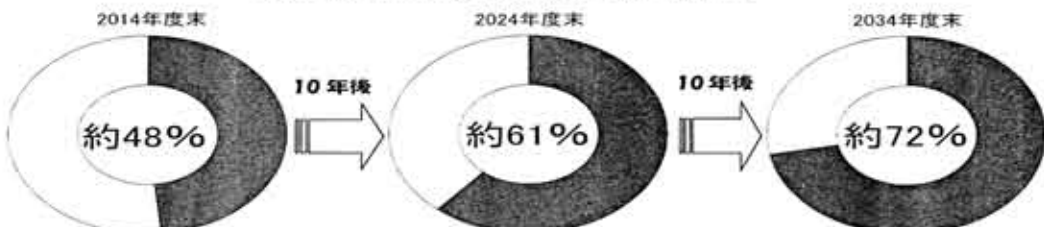
(図表36) 建設後50年以上経過するダム施設数
